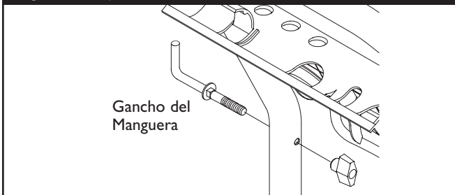
Figura 27 - Fijar el "L" Perno a la Manubrio
